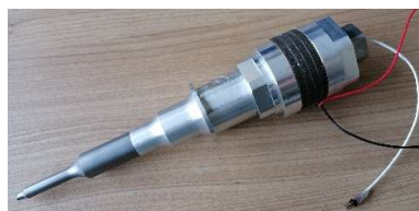
Bild 3: „Direct Torsion“ Konverter mit Booster und Sonotrode für das Ultraschall-Metallschweißen
