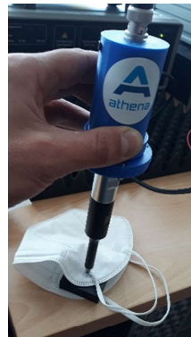
Bild 3: Handgeführter Kompaktkonverter (50 W) mit Sonotrode für Torsions-Kunststoffschweißen
