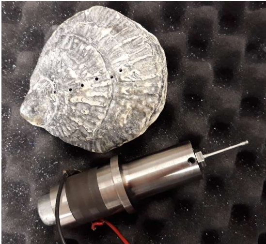
Bild 5 Prototyp eines Ultraschallkonverters mit Werkzeug zum rotationsfreien Ultraschallbohren
