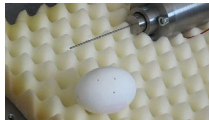
Bild 5: Ultraschallbohren einer Eierschale (rotationsfrei).
