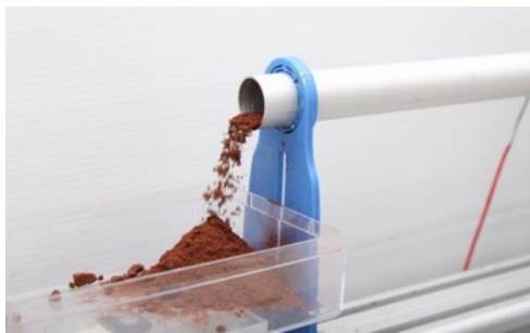
Bild 1: Pulvertransport- und Dosiersystem mit fließendem Kakaopulver
