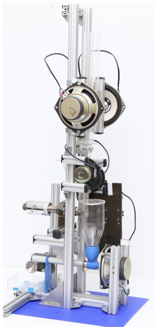
Bild 5: Modular aufgebauter Funktionsdemonstrator zur Handhabung und Verarbeitung feiner Pulver bestehend aus Reservoir mit Entnahmemodul, Dosiereinheit, Ultraschall-Mischkammer, Pulvertransportmodul und Ultraschall-Dispergiermodul.
