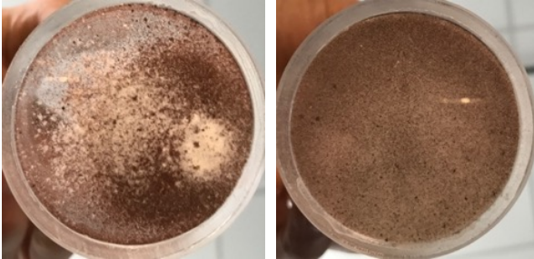
Bild 4: Mischen zweier Pulver ohne (links) und mit (rechts) Ultraschall-Dispergierung
