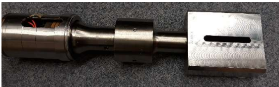
Bild 1: Leistungsupltraschall-Längsschwinger (Konverter, Booster und Sonotrode). Für das Kunststoffschweißen wird der Prozess stirnseitig angekoppelt, zum Metallschweißen müsste das System seitlich, dicht an der Frontfläche, auf die Schweißzone gedrückt werden.
