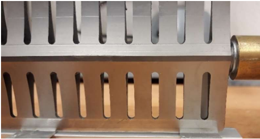
Bild 3: Simultanes Ultraschall-Punktschweißen dünner Metallblechstreifen mit einer ATHENA-Sonotrode (Konzeptstudie). Die Schwingungsrichtung ist horizontal.
