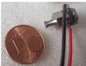
Bild 2 Medizinischer Ultraschallwandler in Integralbauweise (300 kHz)
