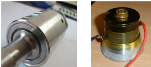
Bild 1 Kommerzielle 40 kHz Leistungsschallkonverter mit vorgespannten Piezoringen zum Ultraschallschweißen (Lühr, links) und für die Reinigung (Morgan El., rechts).
