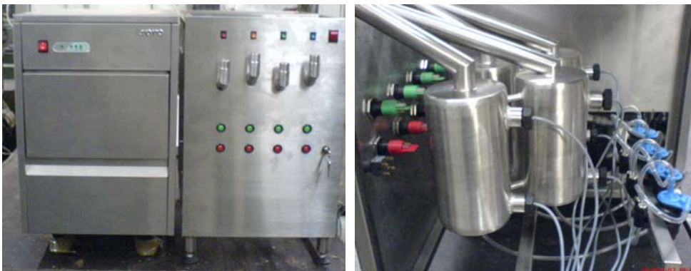
Bild 3: Produktnutzen des Farb- und Aroma-Adapters: Kombinationsmöglichkeit mit bestehenden Eismaschinen (links), ventilgesteuerte Tanks zur Farbgebung und Aromatisierung (rechts)
