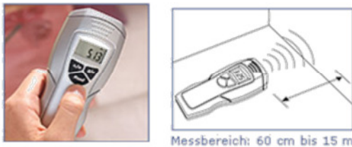
Bild 1 Handgerät zur akustischen Abstandsmessung [TCM]
