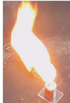
Bild 6: Ultraschallzerstäubtes Petroleum brennt ausgezeichnet, obwohl es unter Normalbedingungen nicht brennbar ist.
