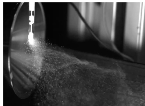
Bild 2: Durch Ultraschall erzeugter Pulvernebel (dispergiertes Mikropulver in Luft)
