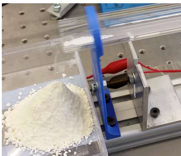
Bild 1: Pulvertransport- und Dosiersystem mit fließendem Mehl
