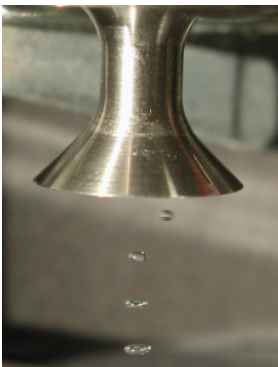
Bild 6 Links: Schweben von Tröpfchen in einem Stehwellenfeld; rechts: Druckamplitudenverteilung unterhalb des Schallwandlers (Refraktovibrometrie). Die Tröpfchen verharren in den Zonen maximalen Schallwechseldrucks (rote Bereiche).
