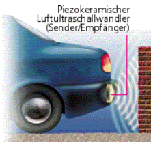
Bild 1 Einparkhilfe im Kfz. Der Ultraschallwandler sendet eine Welle aus, schaltet anschließend auf Empfang und berechnet den Abstand zur Wand aus der Wellenlaufzeit (Quelle: CeramTec).
