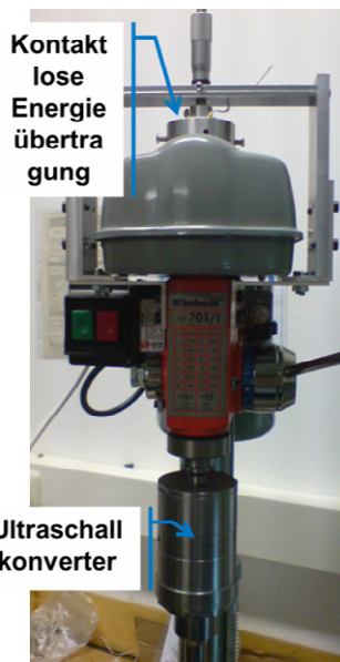
Bild 6 Funktionsdemonstrator mit rotierendem Ultraschallkonverter mit kontaktloser Ultraschalleinkopplung
