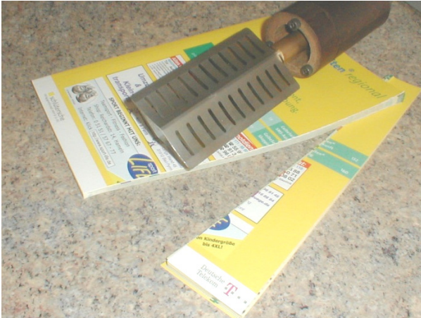
Bild 3 Mit ATHENA-Sonotrode durch Ultraschallschwingungen zerschnittenes Telefonbuch
