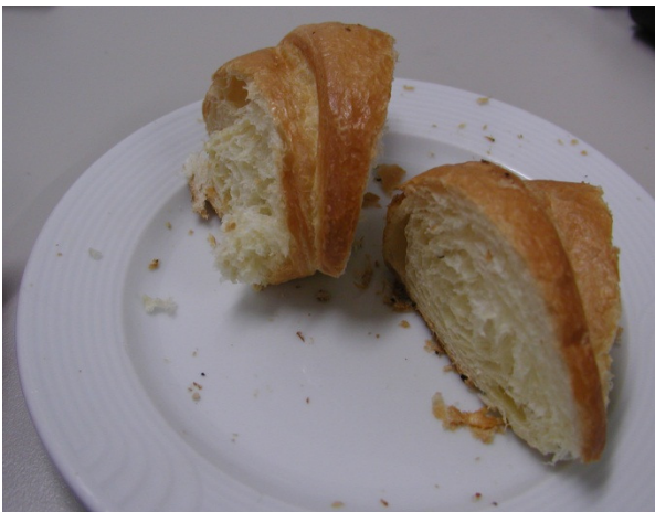
Bild 4 Ohne (links) und mit Ultraschallunterstützung (rechts) zerschnittenes Croissant
